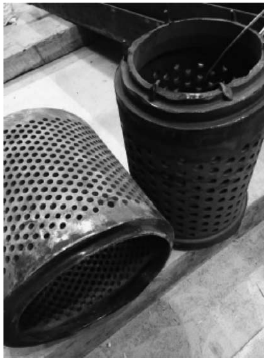
图3 断裂的二、三级减压器
