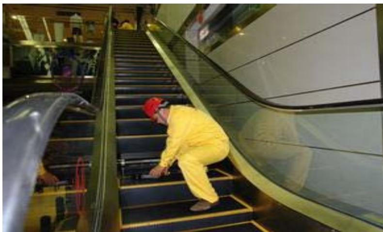
图 22：检验人员在电梯进行检验
